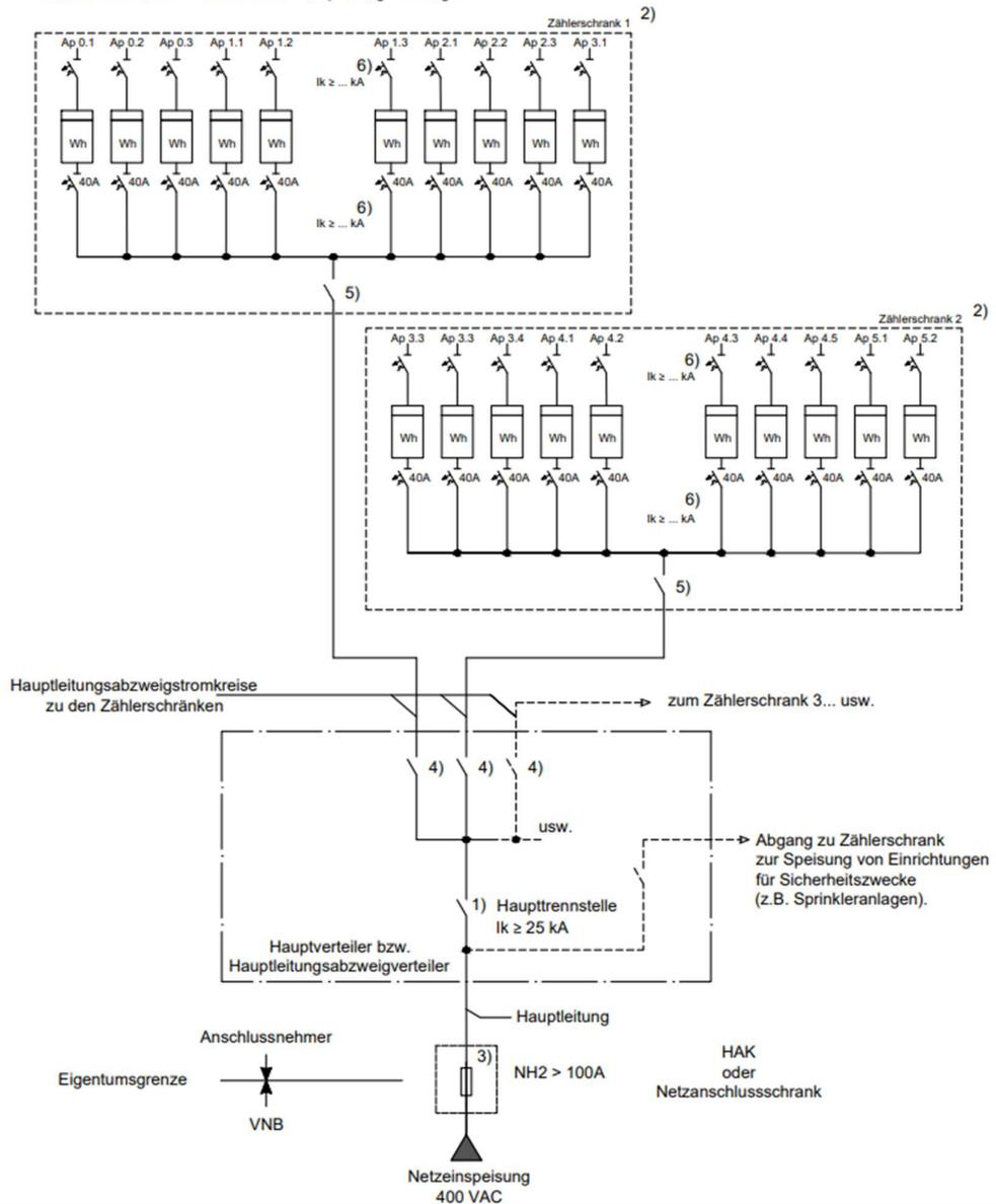
Ausführungsbeispiel – Anschluss einer Residenz mit mehreren Zählerschränken und einem Hauptleitungsabzweigverteiler – Einbau der Haupttrennstelle im Hauptleitungsabzweigverteiler
