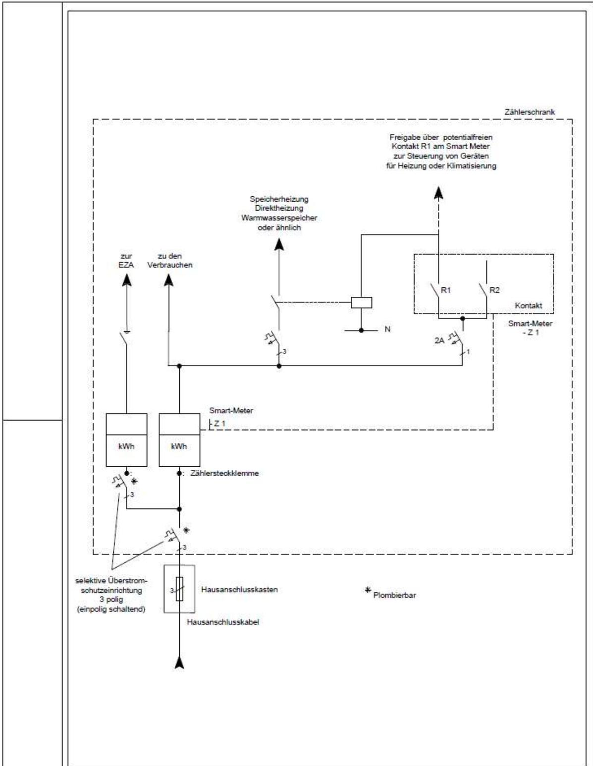
Anschluss und Steuerung von Geräten zur Heizung oder Klimatisierung
