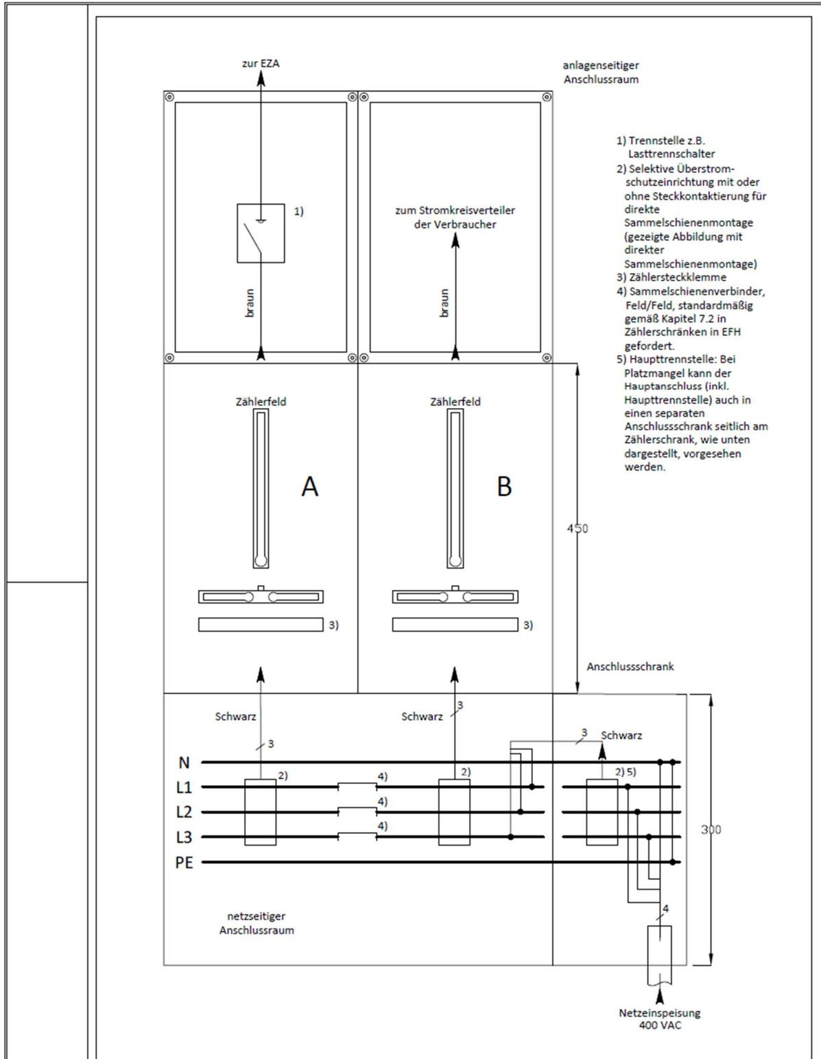
Aufbau und Leitungsführung einer Zählertafel bei einer Einspeisung der gesamten Energieproduktion ins Niederspannungsnetz nach Anhang A3 (Unterschiedliche Anschlussnehmer)
