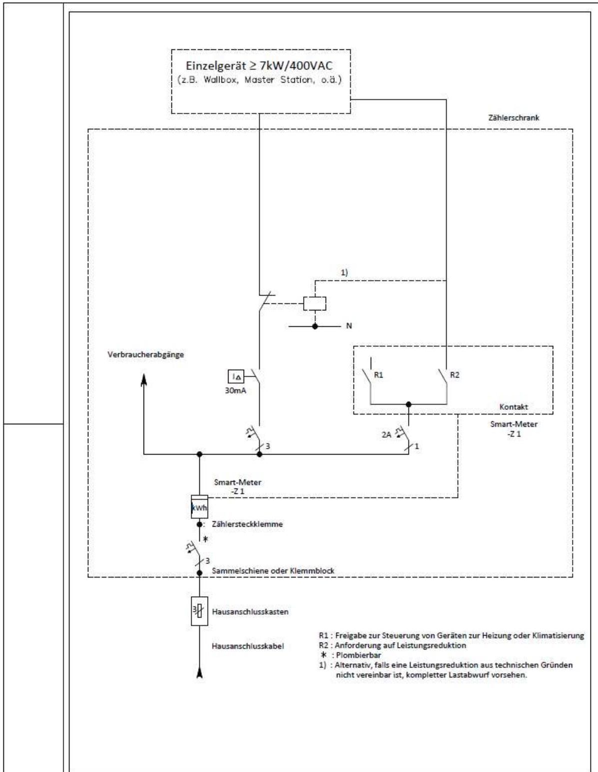
Anschluss und Steuerung von Geräten  $\geq 7 \text{ kW}/400 \text{ VAC}$
