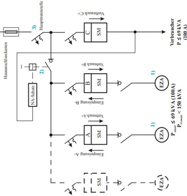
1) Bis  $S_{max} \leq 30$  kVA (Gesamtproduktion am Netzanschluss) integrierter NA-Schutz und Kuppelschalter zulässig
