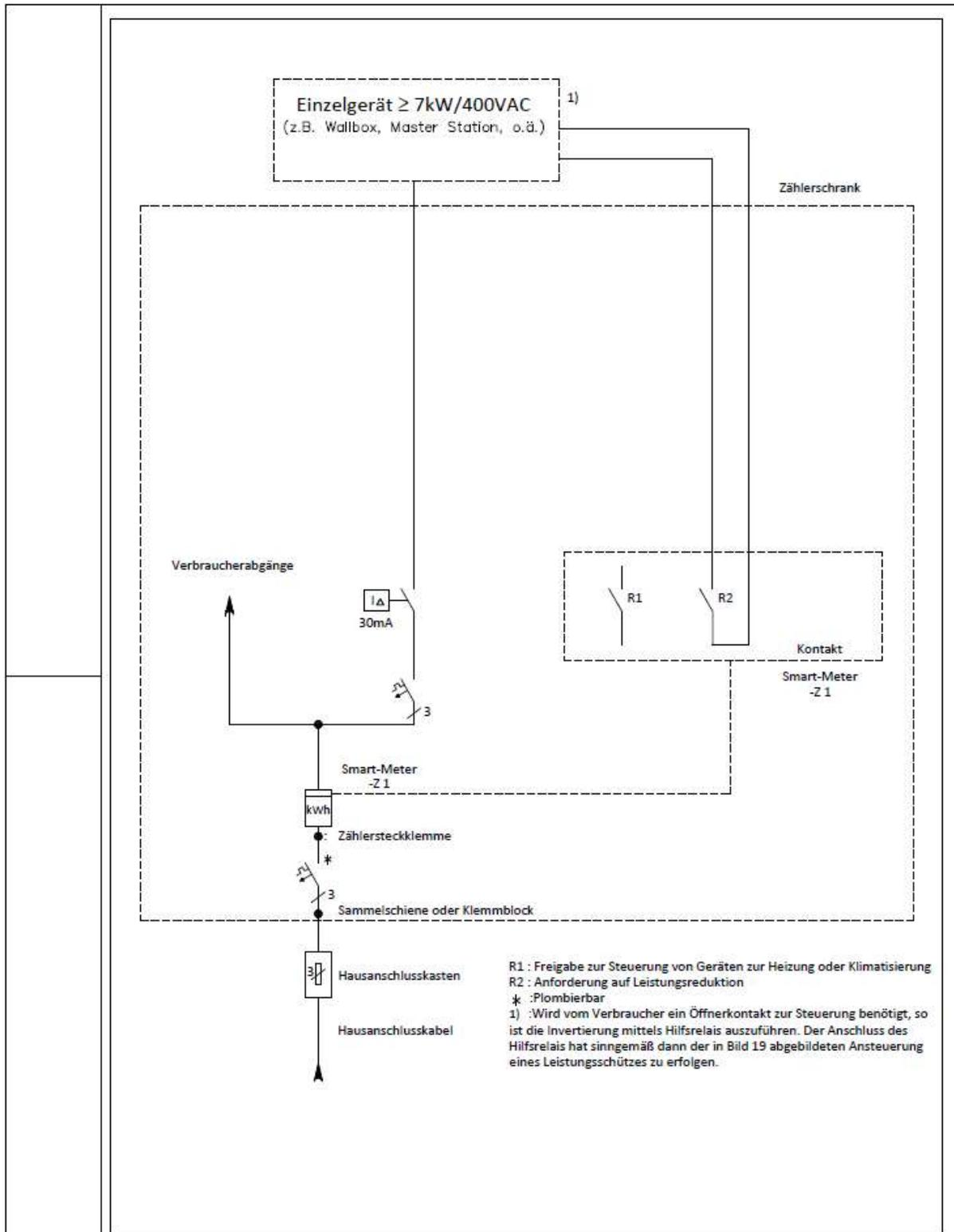
Anschluss und Steuerung von Geräten  $\geq 7\text{kW}/400\text{VAC}$ , gemäß Kapitel 9.3.6. dieser TAB-BT (Potentialstellung durch das Gerät)
