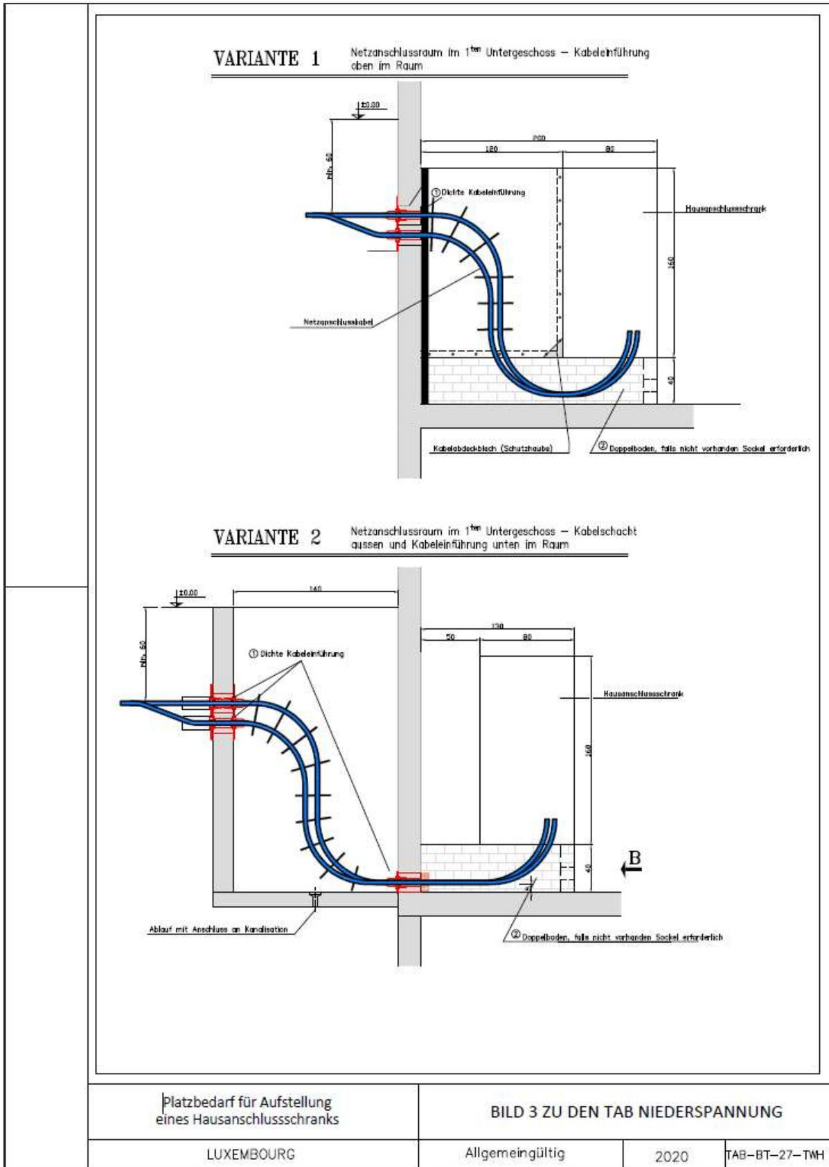
**Bild 4: Anschlussschema Kabelhausanschluss**
