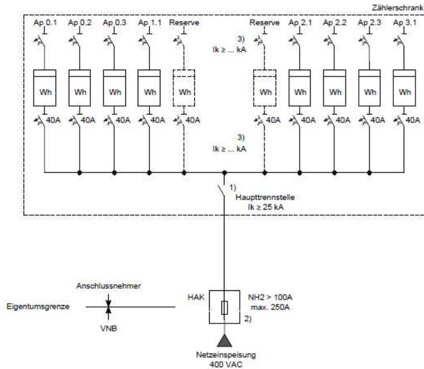
Prinzipschema Anschluss Residenz mit nur einer Zählertafel und ohne Hauptverteiler. Haupttrennstelle in Zählerschrank
