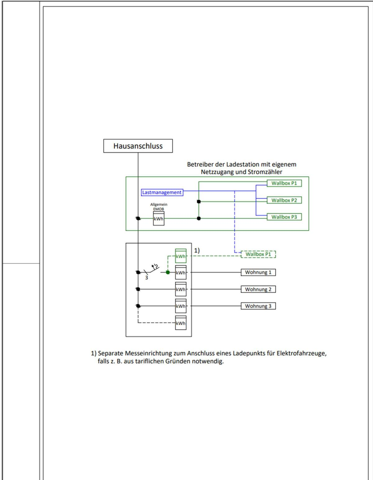
1) Separate Messeinrichtung zum Anschluss eines Ladepunkts für Elektrofahrzeuge, falls z. B. aus tariflichen Gründen notwendig.
